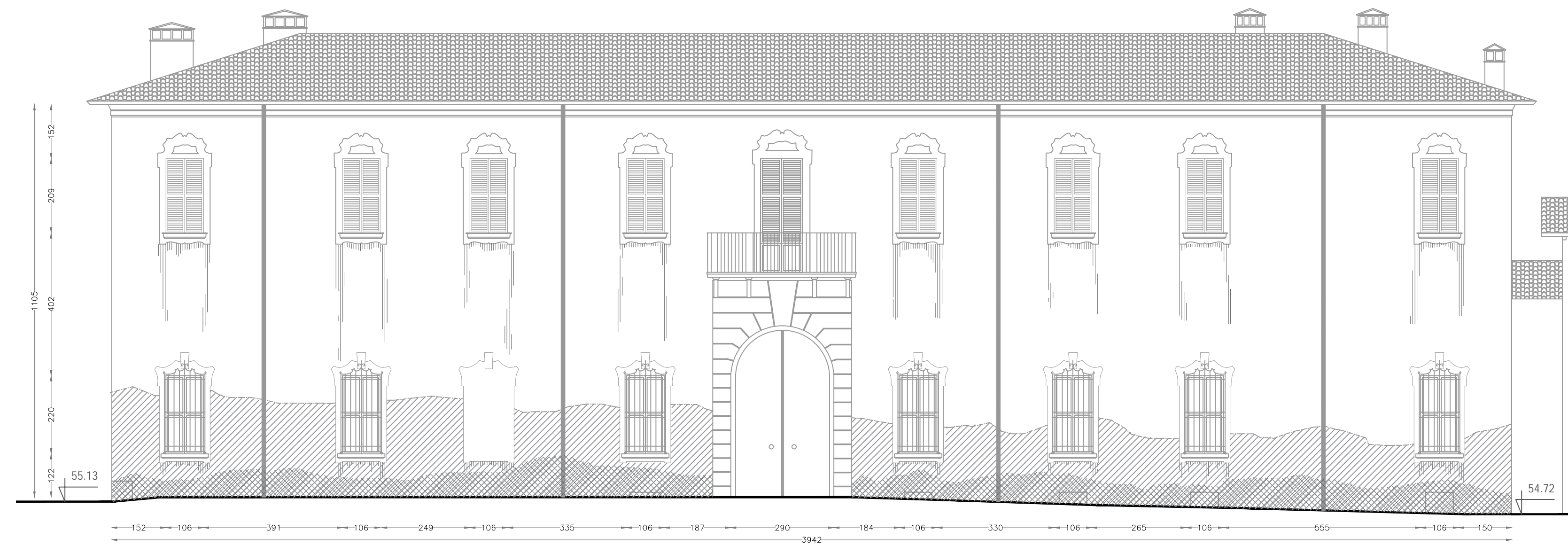
Prospetto nord su Corso Libertà con analisi degrado materico, scala 1:100
